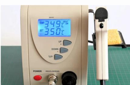
Bild 3: Das große, blau beleuchtete Display der Basisstation zeigt die reale und die eingestellte Temperatur an.
