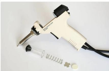
Bild 2: In diesem Glasrohr wird das Lot aufgefangen wird. Eine Feder hält eine Metallplatte und eine Filzscheibe in Position, wenn das Rohr gewechselt wird.
